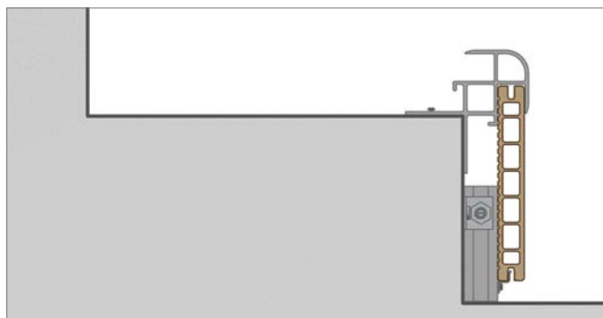
2. Mocowanie aluminiowego profilu schodowego
